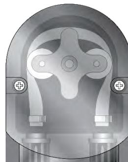
Закройте крышку насоса и сильно надавите на его поверхность, чтобы он правильно зафиксировался.
