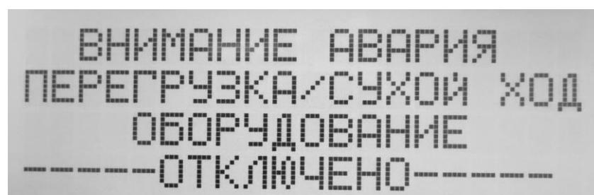
Примечание: В случае "Сухого хода", пульт управления «PoolStyle PCU-1P», перед тем как выйти в режим аварии, три раза попытается прокачать насос фильтровальной установки.
