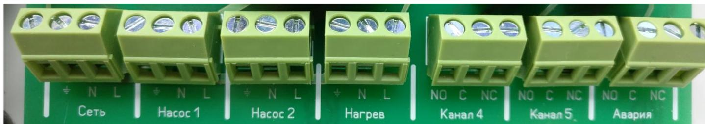
К клемме **СЕТЬ** подключается три кабеля питания. Запрещается менять местами «Фазовый» и «Нулевой» провода. Подключать нужно в точности в соответствии с рисунком.
