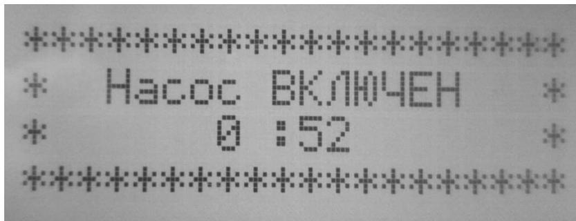
В связи с отключением автоматики защиты, использовать данный режим необходимо с осторожностью. Следите за наличием воды в насосах фильтровальной установки. В случае ее отсутствия нужно немедленно выключить панель управления.
